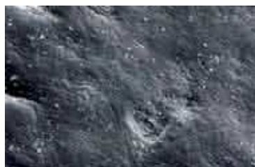
Rysunek nr 1: Obraz z SEM pokazujący obszary demineralizacji oraz mikrometryczne zarysowania pojawiające się na powierzchni szkliwa zębowego jako wynik mikrozużycia i działania substancji kwaśnych. (Powiększenie rzędu 4000 razy).
